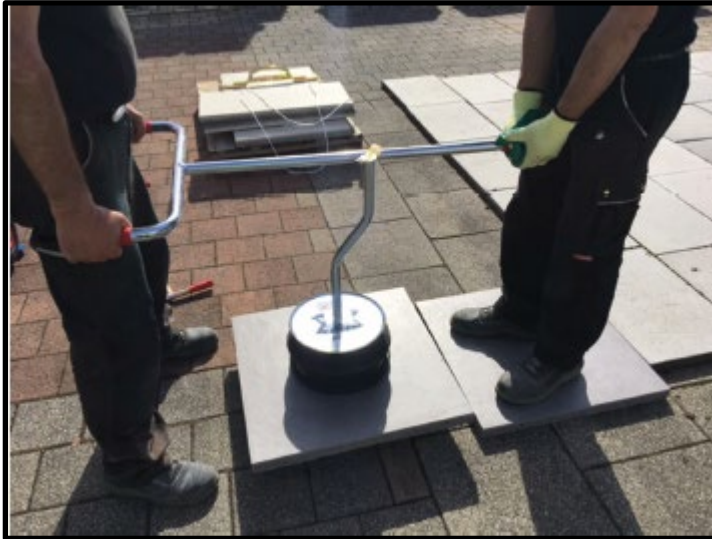
VAKUUM-HANDY VH-2/50, Tragfähigkeit bis 50 kg
